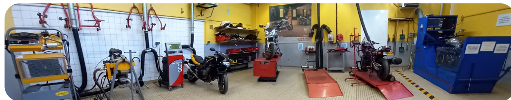
Salle moteur diagnostique et banc de puissance
